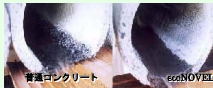
流水試験状況(60日後-20℃、5%硫酸水溶液)
