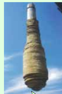
埋込み杭工法の拡大根固め球根
