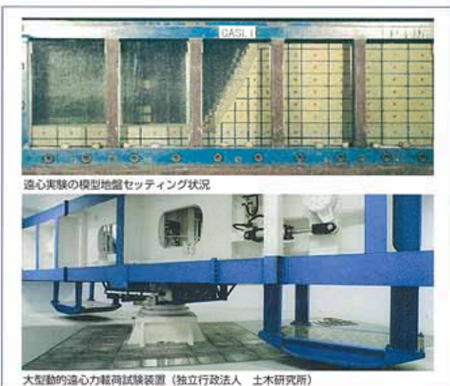
大型動的遠心力荷試験装置（独立行政法人 土木研究所） マニュアルとは箱型擁壁工法 技術資料 設計・施工・緑化マニュアルです。
